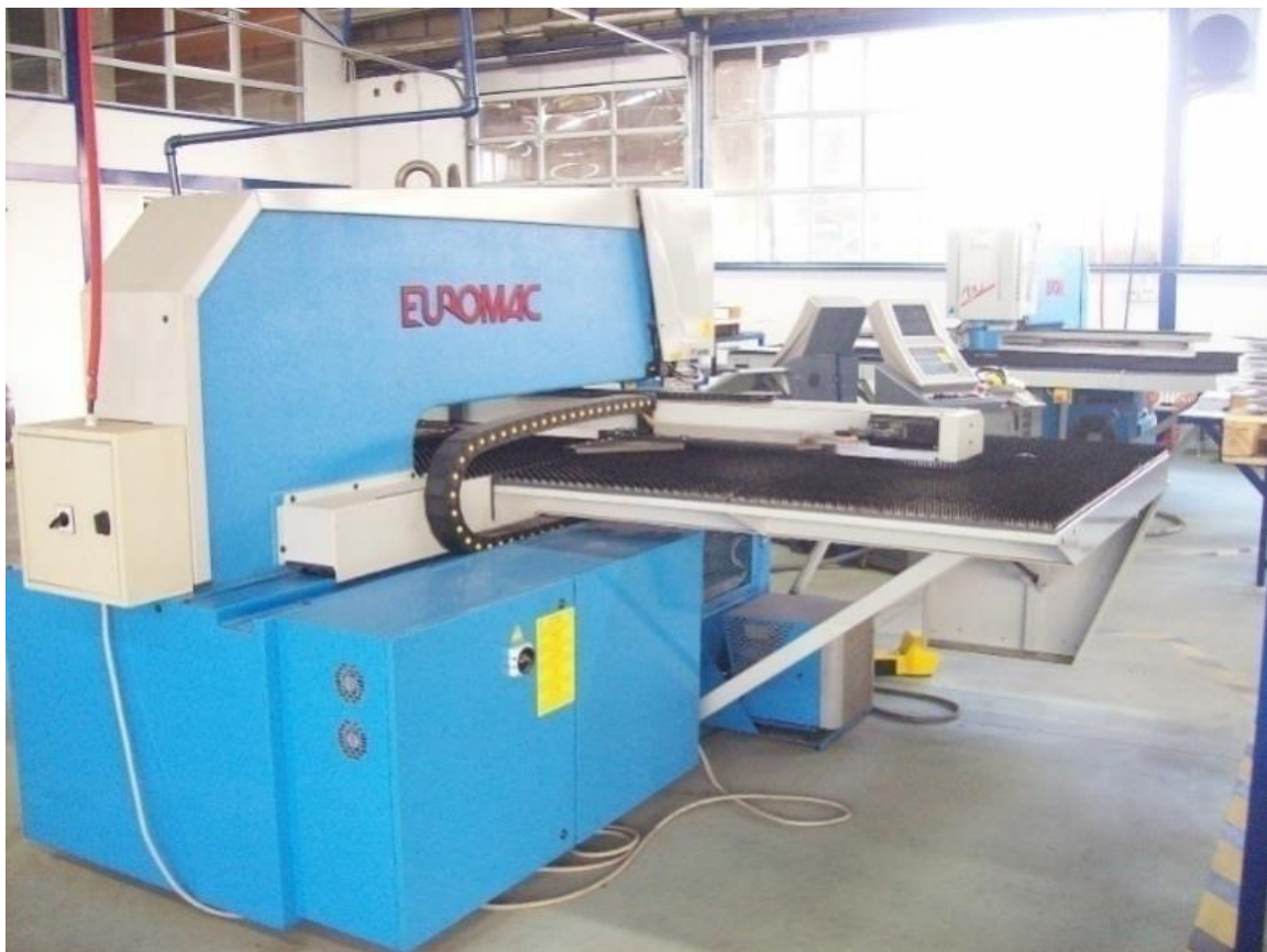
Слика 1 Машина за пробивање и просекување на лимови
